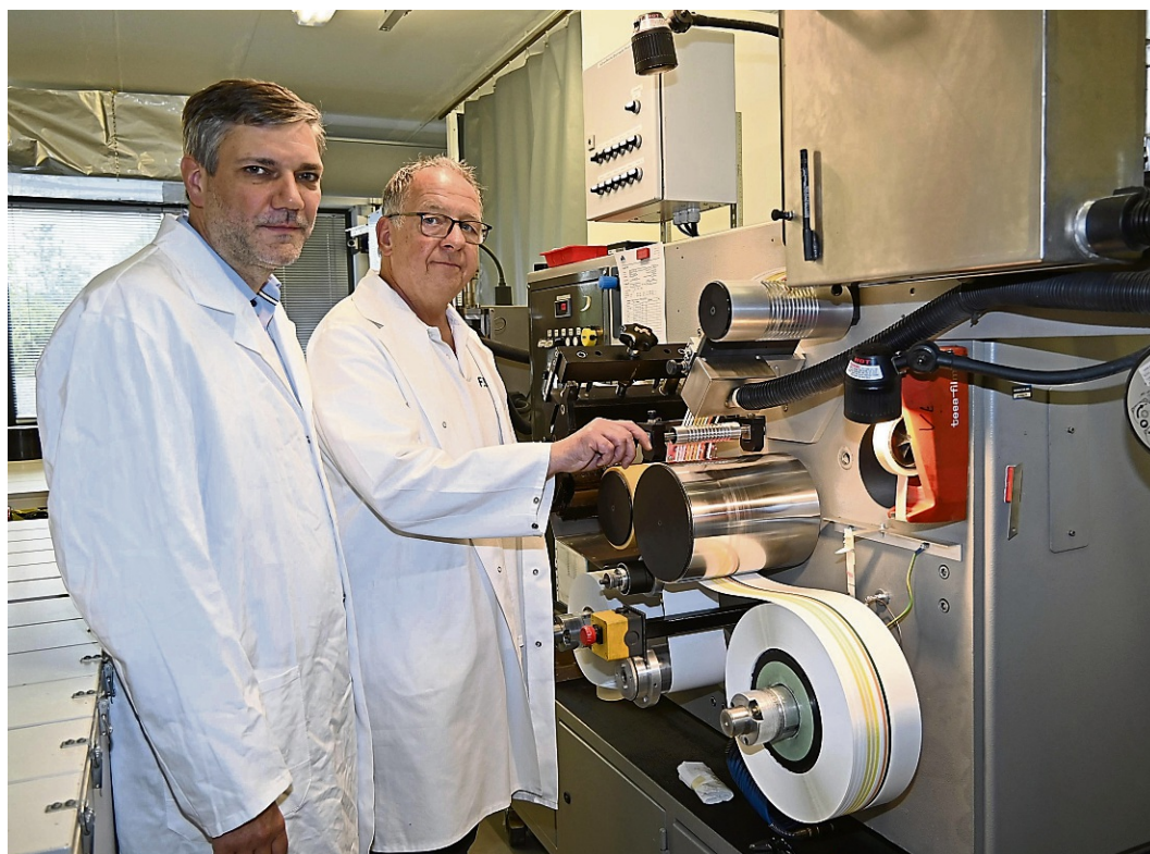
Präzisionsarbeit: (von links) Geschäftsführer Dr. Stephan Busche und Gruppenleiter Produktion, Frank Solka, zeigen, wie die Teststreifen mit Folie laminiert werden. Jede Farbe steht für ein anderes Festfeld.
