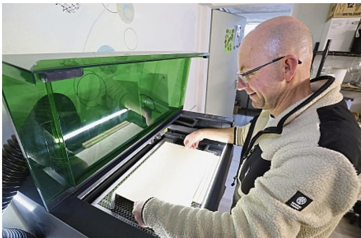
Beim Vorbereiten des Lasers: Eine Sperrholzplatte im maximalen DIN A 3-Format wird eingespannt.
