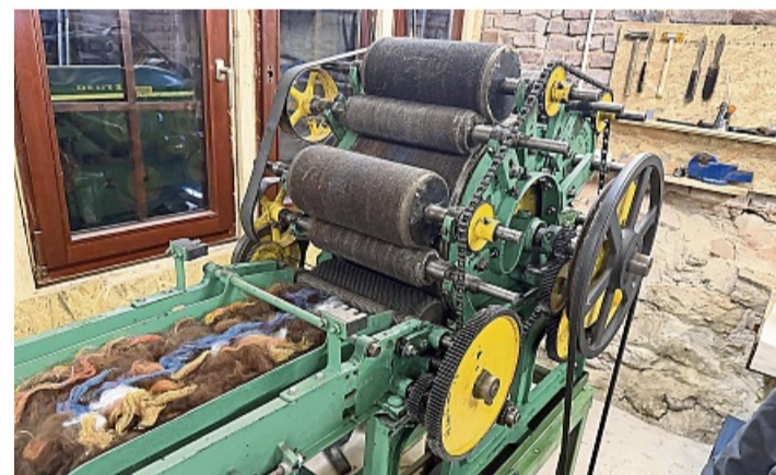
Auf den Walzen sind feine Nadeln, mit denen die Wolle kardiert wird.
