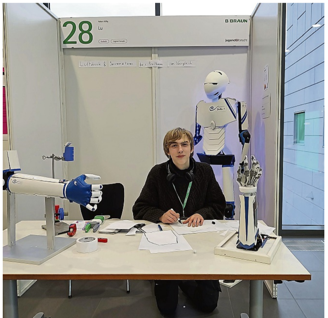
Mit „Lu“ entwickelte Robert Killig eine fernsteuerbare Roboterhand auf Arduino-Basis. Servomotoren steuern die einzelnen Finger präzise an, perspektivisch ist eine sprachgesteuerte Bedienung geplant. Das Projekt wurde mit dem zweiten Platz ausgezeichnet. FOTO: KAMIL DANIEK
