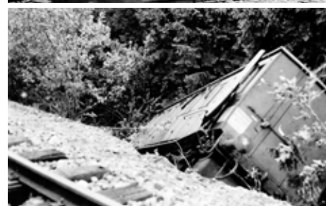
Bei der Belastungsprobe sind beide Lokomotiven (Foto oben) und ein Personenwagen (Foto unten) entgleist.
