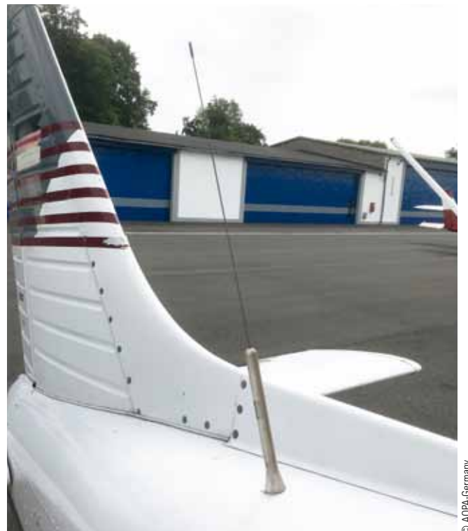
ELT-Antenne am hinteren Rumpf eines Flugzeuges
