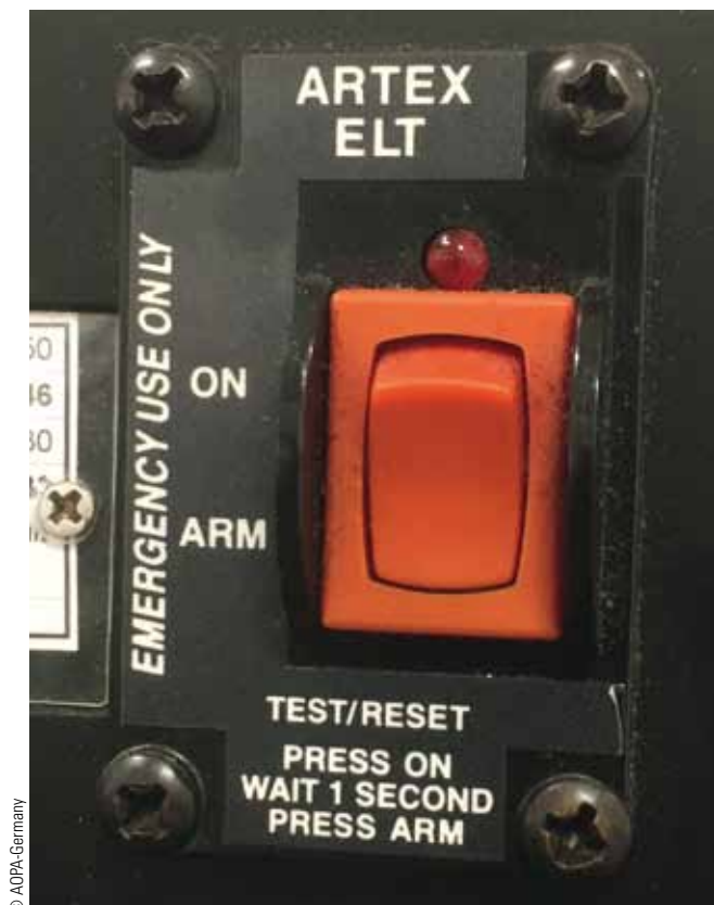
ELT-Bedieneinheit im Cockpit
