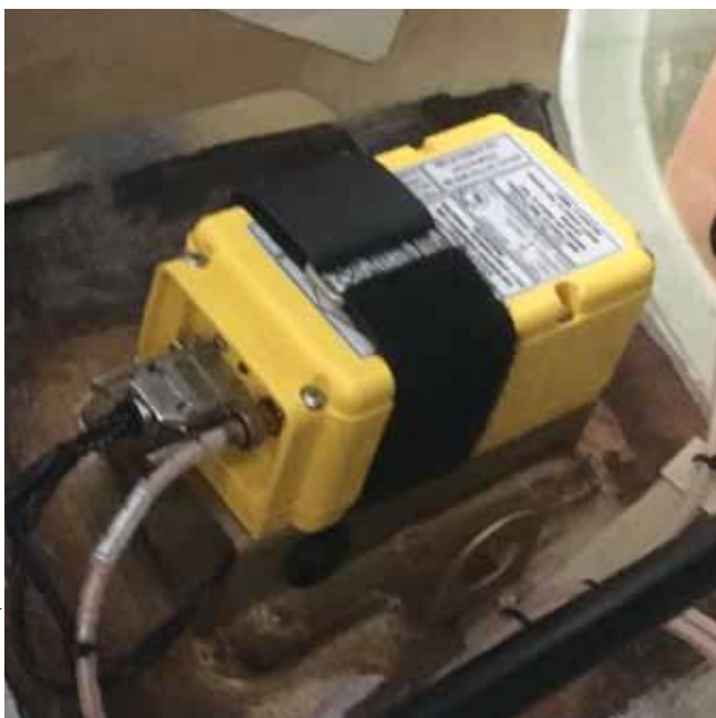
ELT, eingebaut im hinteren Teil eines Flugzeuges
