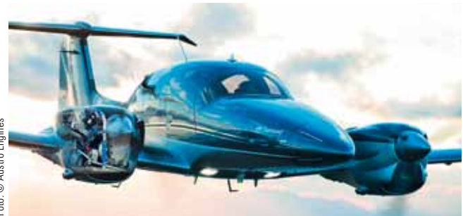
DA62 mit 180 PS AE330 Triebwerken
