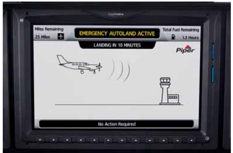
Der Bordcomputer informiert sowohl die Passagiere als auch die Flugsicherung über den Ablauf der Notlandung. Quelle: www.garmin.com
