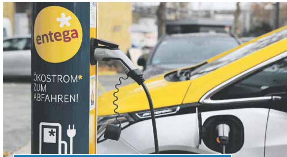
In etwa drei Stunden an einer ENTEGA-22kW-Ladesäule aufgeladen, ein Renault Zoe aus dem E-Carsharing-Angebot für Kommunen. Foto: ENTEGA
