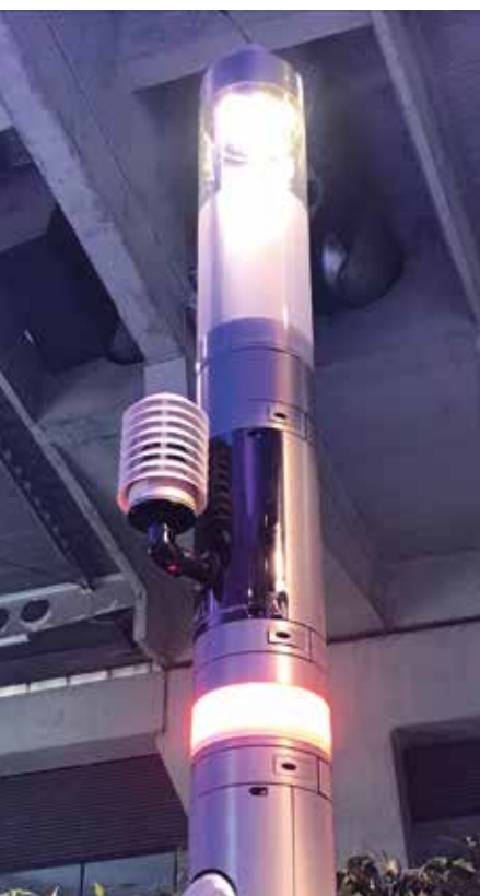
Sensoren zur digitale Luftmesstechnik FOTO: Urban Lighting Innovations GmbH
