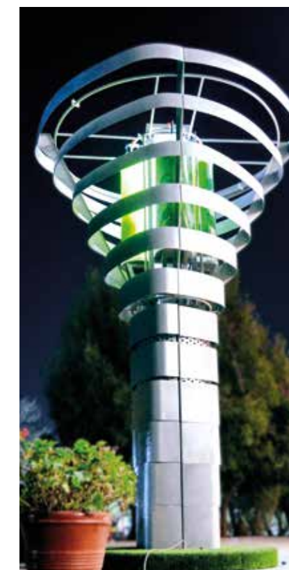
Mit künstlichen Bäumen für eine bessere Luft in der Stadt: Ein Unternehmen in Mexiko hat ein Gerät konstruiert, das mit Hilfe von Mikroalgen die Luft von Kohlendioxid und Schadstoffen befreit. Nach Angaben von BiomiTech kann ein einziger dieser künstlichen Bäume die Arbeit von 368 echten Bäumen ersetzen. FOTO: BiomiTech
