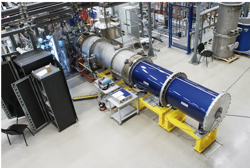
Kalttest an der neuen Testeinrichtung im russischen Dubna. Wegen des besonderen Designs der Quadrupoleinheiten musste eigens ein spezielles Kühlgerät, der Testkryostat (blau), entwickelt und gefertigt werden.
