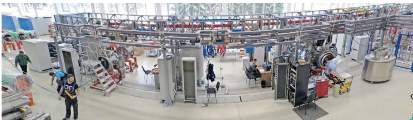
Serientesteinrichtung für supraleitende Magnete am Joint Institute for Nuclear Research (JINR) in Dubna für die beiden Beschleunigerzentren FAIR und NICA.
