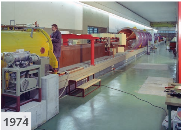
Der Linearbeschleuniger UNILAC, der alle natürlich vorkommenden Elemente auf Geschwindigkeit bringen kann, wurde mehrfach umgebaut.
