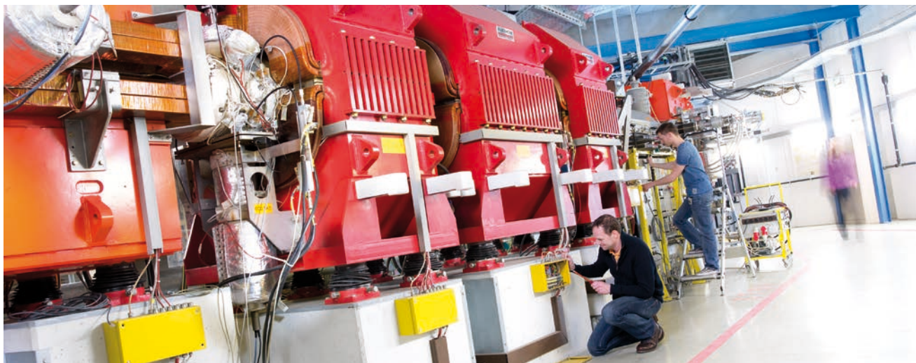
Der GSI-Experimentierspeicherring ESR ermöglicht Energiebestimmungen mit höchster Präzision.
