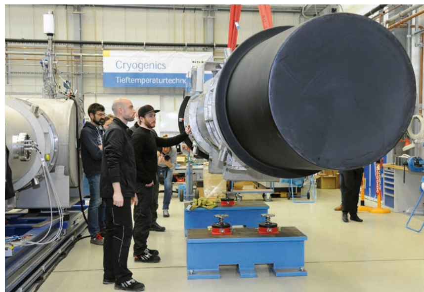
Am Haken: Vorsichtig wird das Quadrupolmodul mit dem Kran an seinen Platz gehoben.
