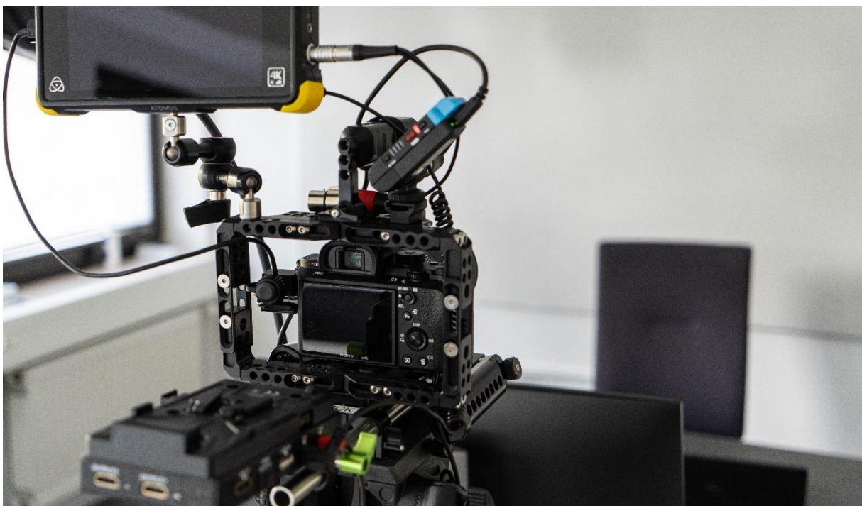
Abb. 84: Basis Vorlesungsaufzeichnung-Setup: Shogun Recorder, Sony Alpha S II, Sennheiser AVX
