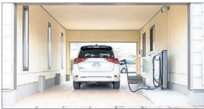
Der Akku des Mitsubishi Outlander Plug-in Hybrid lässt sich an Haushaltssteckdosen (230 V/10 A) binnen 5,5 Stunden aufladen, an Schnellladestationen werden nur 25 Minuten für 80 Prozent benötigt. Foto: Mitsubishi Motors
