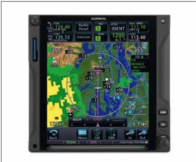
Garmin GTN750 ADSB, mit Darstellung von Wetter und anderem Verkehr
