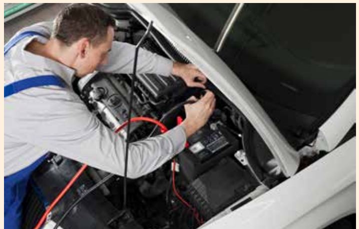
Das Laden der Batterie ist bei modernen Fahrzeugen ein Job für die Werkstatt. Foto: ProMotor/T. Volz
