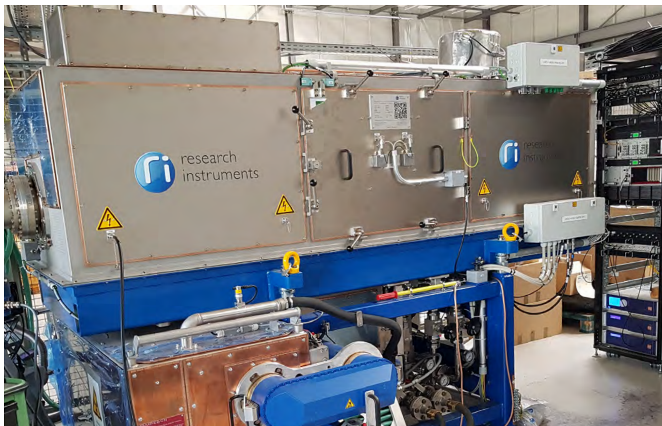
Von RI Research Instruments realisierte Kavität inkl. der hauptsächlich von der GSI-Abteilung „Ring RF“ entwickelten Elektronik im Hintergrund.
