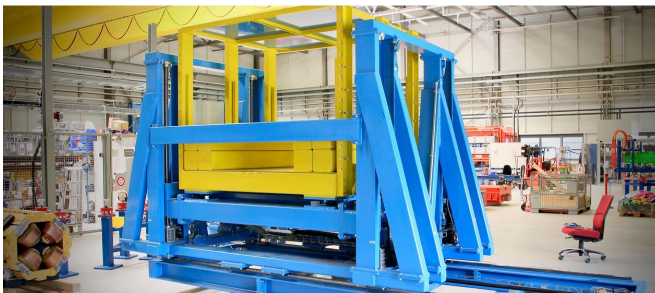
Manipulator für den PSD-Detektor des CBM-Experiments an FAIR.
