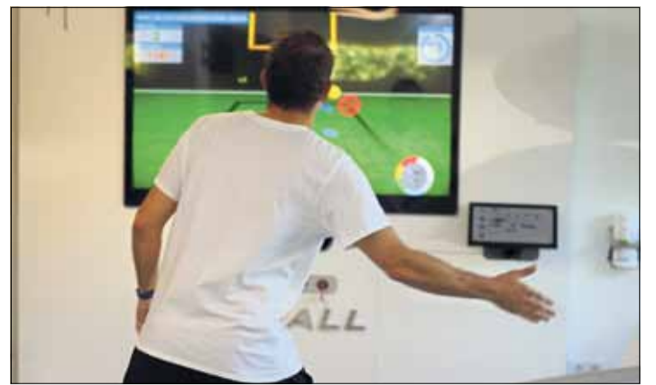
Die D-Wall ist das Glanzlicht des medizinischen Trainingszentrum. Sie erkennt in Echtzeit bis zu 16 Körpergelenke.
