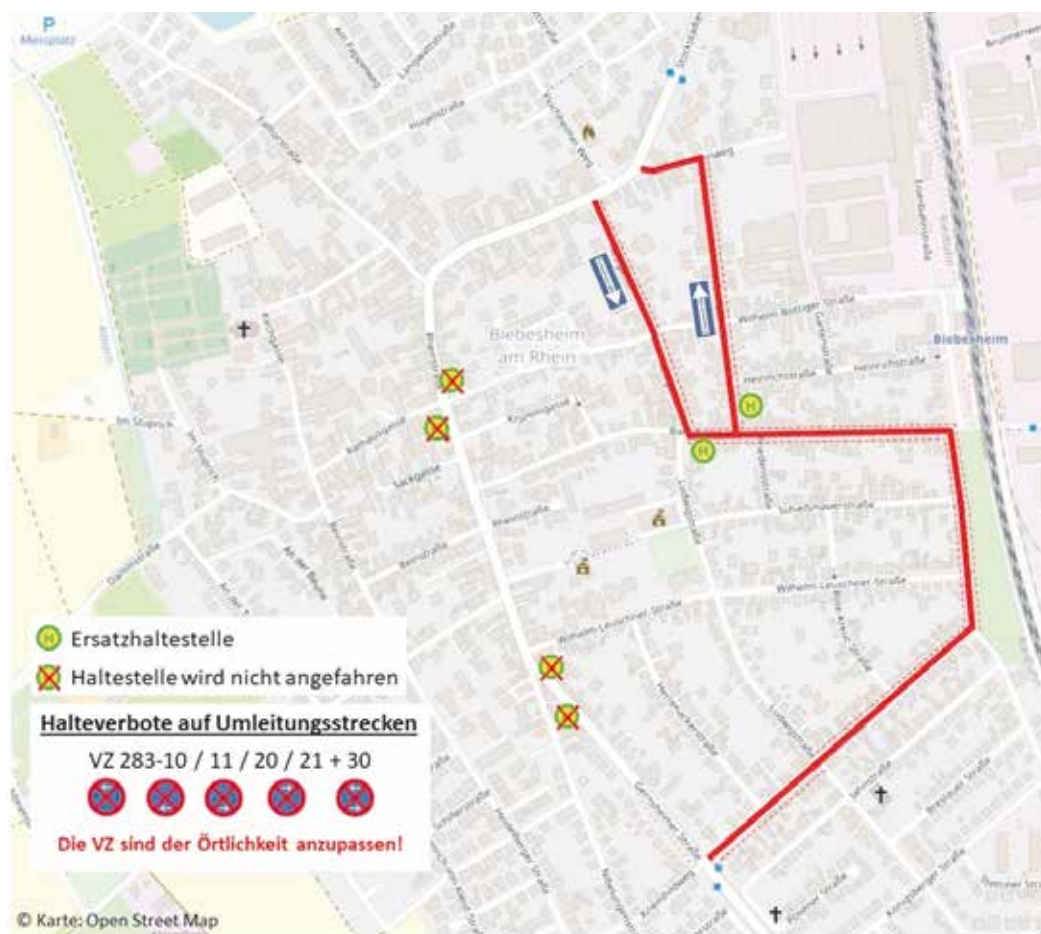
Bauabschnitt 1 bis 5: Umleitung, Halteverbote und Ersatz-Bushaltestellen
