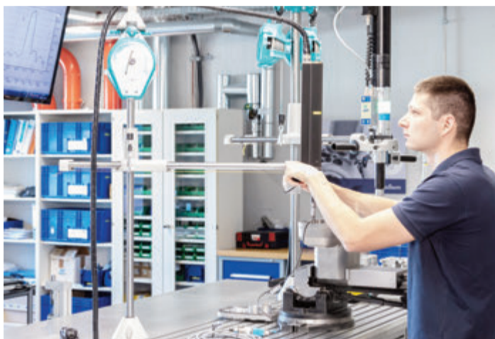
Präzision im Anwendungslabor: Maxim Ort testet die Grenzen einer Schraubverbindung in einem Kundenbauteil. Am Torsionsprüfstand hat der Anwendungstechniker vor allem das Furch- und Versagensmoment sowie die Vorspannkraft der Schraube im Blick.
