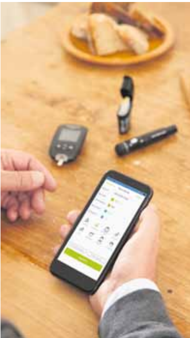
Jeder gemessene Blutzuckerwert wird vom Messgerät automatisch per Bluetooth in die App übertragen.
