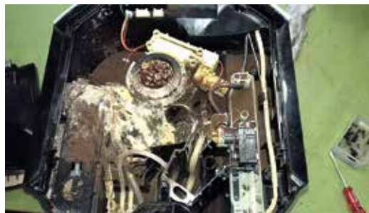
Hier sieht man, wie sich im Laufe der Jahre Schimmel im Innenraum der Kaffeemaschine bildet.
