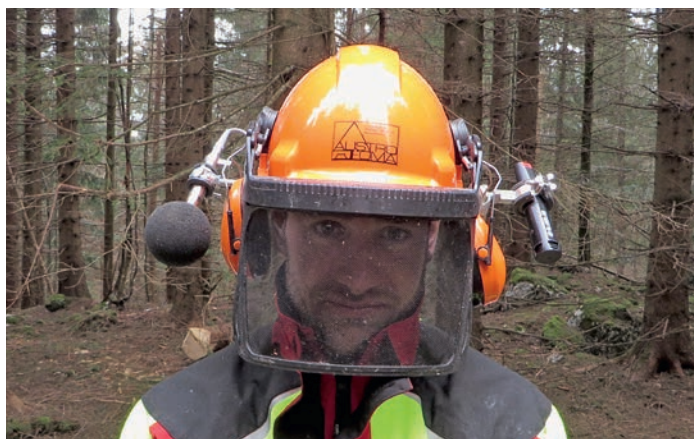
Abbildung 4: Mikrophonmontage zur Schallpegelmessung am Forsthelm, Miniatur-Schallpegelmesser Svan 971 mit Mikrophon und Windschutz
