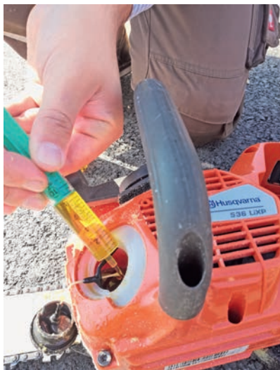
Abbildung 3: Ermittlung des Kettenölverbrauchs der Motorsägen mittels Kunststoffspritze
