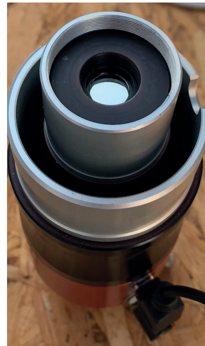
Abb. 6: Das Sonnenlicht tritt über diesen 12 mm großen Bandpassfilter (Blockfilter) in das Filtersystem des H \alpha -QUARK-Okularfilters der ein und sorgt für eine drastische Reduktion der Wärmentswicklung.
