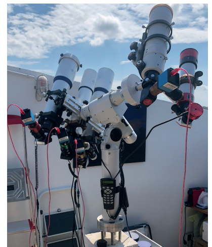
Abb. 3: Der sog. Sonnenturm der Sternwarte Meckesheim: Mit den beiden Teleskopen auf der rechten Seite können Übersichtsbilder der Sonne im Bereich 535-545 nm und im Licht der H \alpha -Linie sowie im Licht der Ca K-Linie bei 393,4 nm aufgenommen werden. Die drei Refraktoren auf der linken Seite sind mit QUARK-Okularfilter ausgestattet und ermöglichen simultane Aufnahmen im Licht von H \alpha (656,3 nm), Na D2 (589,0 nm) und Mg I b2 (517,3 nm). Der Einsatz verschiedener Filter erlaubt u.a. die Untersuchung spezieller solarer Phänomene in verschiedenen Entwicklungsstadien.
