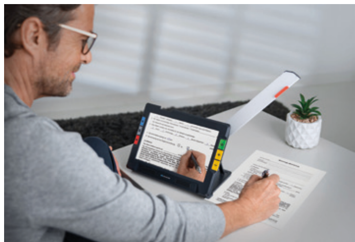
Mit dem ausschwenkbaren Kameraarm lässt sich eine ganze DIN-A-4-Seite erfassen und gleichzeitiges Lesen und Schreiben ermöglichen. Foto: dj-d-k/A. Schweizer/Wolfgang Rottmann
