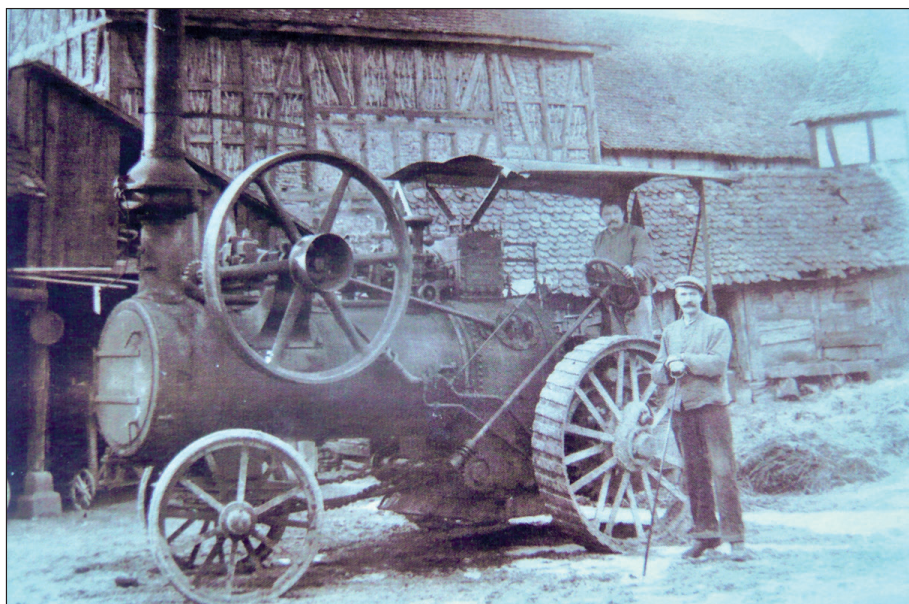
Ein Lokomobil der Münsterer Müllerfamilie Huber im Jahre 1910. Zwischen Schuppen und Scheune fließt noch der Mühlbach, der bis zum Jahre 1923 über eine Holz- bzw. Metallrinne dem Wasserrad die potentielle Energie des Wassers von oben herab „oberschlächtig“ zuführte, und somit viel Kraft bei minimaler Wassermenge erzeugte.
