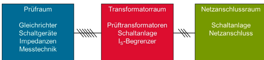
Bild 1: Anlagenteile des DC.lab und ihre jeweiligen Komponenten
