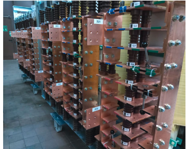
Bild 5: Prüftransformatoren des DC.lab
