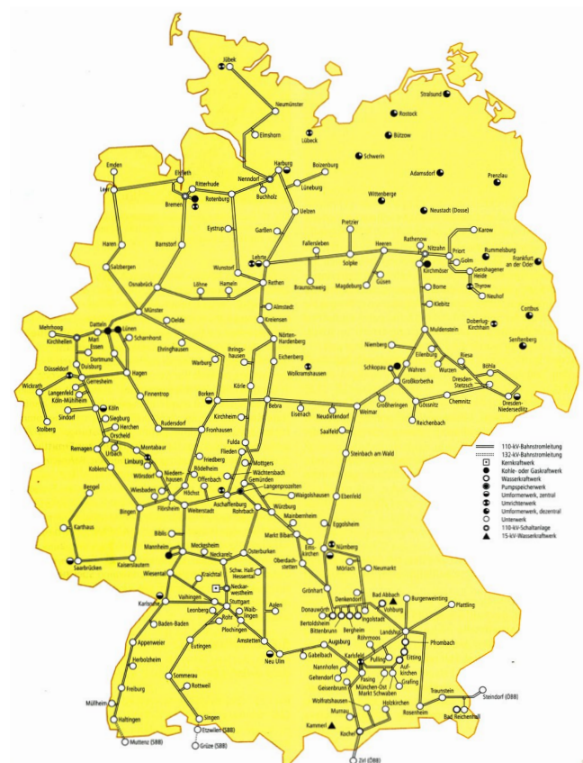
Bild 14: Bahnstromnetz, Erzeuger-, Übertragungs- und Verteileranlagen
