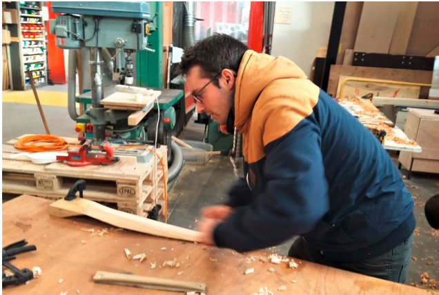
In der Werkstatt beim Bau eines Piggott-Windrades
