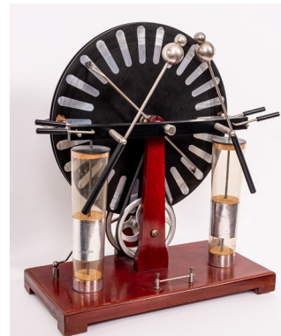
Bild 1.2: Seit dem frühen 20. Jahrhundert dienen Influenzmaschinen, von Ausnahmen abgesehen, nur noch didaktischen Zwecken. Hier eine solche Maschine (Platten-Durchmesser 31 cm) in der vom britischen Erfinder James Wimshurst geprägten Ausstattung; hergestellt von Voluta, Deutschland, um 1935.
