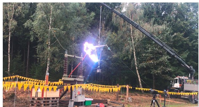
Bild 1: Künstlich getriggert Erdschluss in einem gelöschten 110-kV-Netz
