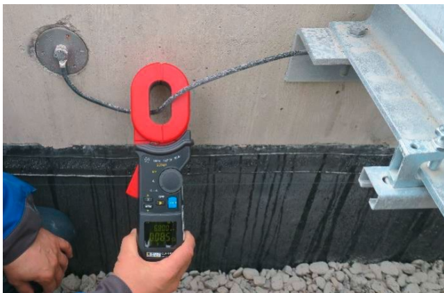
Bild 14: Erdungsmessung (Quelle: VDE-Fachbericht 77)
