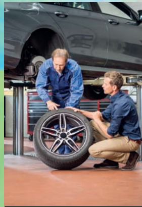
Die Kfz-Fachwerkstatt kontrolliert eingelagerte Winterreifen vor der Montage auf Profiltiefe und Schäden. Foto: djd/Kfzgewerbe/Timo Volz
