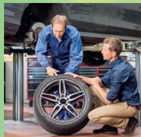
Die Kfz-Fachwerkstatt kontrolliert eingelagerte Winterreifen vor der Montage auf Profiltiefe und Schäden. Foto: djd/Kfzgewerbe/Timo_Volz
