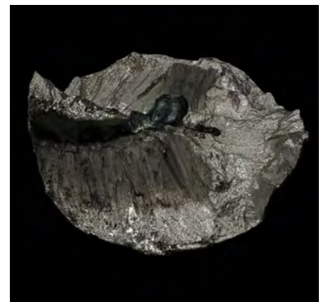
Bruchbild mit typischem Versagen im Bereich der Schweißnaht aufgrund von Fehlstellen, Schweißzustand Integralprobe A-10, Grundwerkstoff EN-GJS-400-18-LT.
