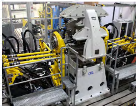
Straßensimulator zur Validierung von kompletten Fahrwerkssystemen.
