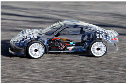
Beispielhafte Umsetzung von vibroakustischen Metamaterialien an einem Fahrzeugmodell.
