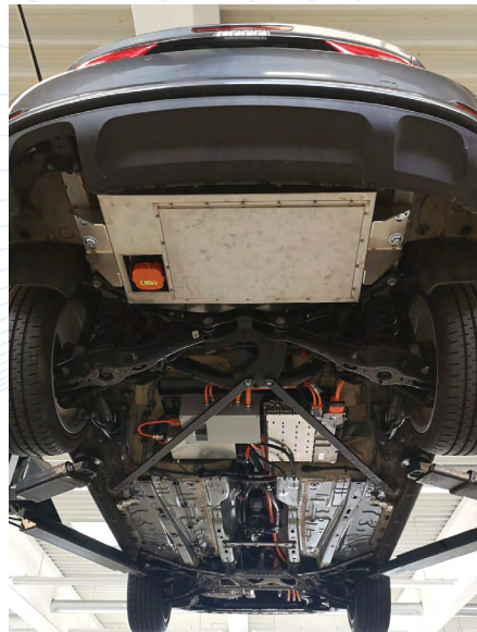
HyPowerRange-Energiespeichersystem im Versuchsfahrzeug.
