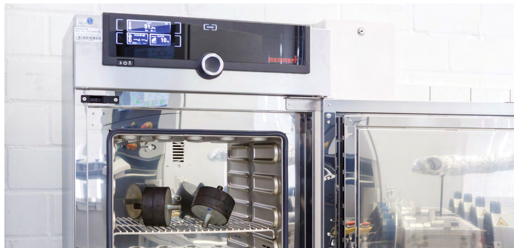
Thermo-oxidativer Ofen zur künstlichen Alterung.
