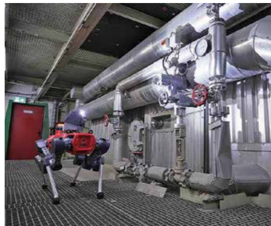
Der Robodog kann in Bereichen eingesetzt werden, in denen die Arbeit wegen Lärm oder Hitze für die menschlichen Kollegen sehr belastend ist.
