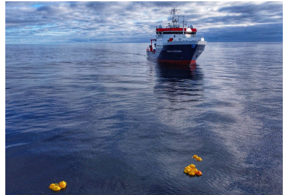
▲ Foto 3.1-2: Das deutsche Forschungsschiff MARIA S. MERIAN in der Labradorsee steuert auf Teile einer Langzeitverankerung zu, die zur Wartung der Komponenten jährlich eingeholt werden. Des Weiteren werden eine ganze Reihe von ECVs auf dem Schiff vermessen.
