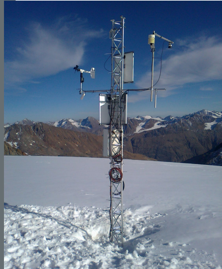
◀ Foto 6.2-2: Automatische Wetterstation am Hochvernagtplateau in 3.450 m Höhe. An dieser Station wird die Entwicklung der Schneedecke kontinuierlich beobachtet und gleichzeitig werden die wichtigsten meteorologischen Komponenten aufgezeichnet.
