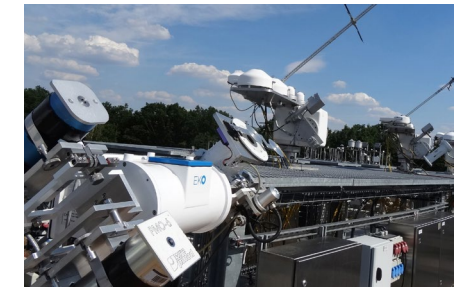
▲ Foto 2.5-2: Präzisionsmessungen der einfallenden Strahlungsflüsse an der BSRN-Station Lindenberg
