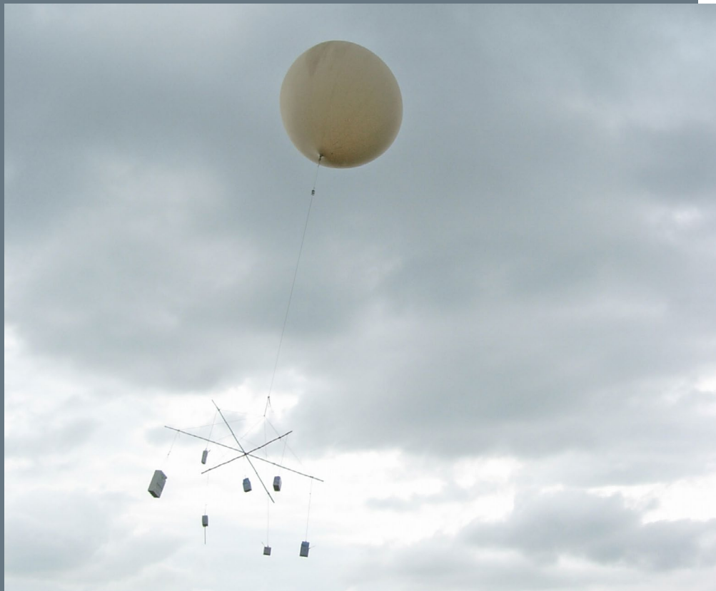
◀ Foto 5.7-1: Aufstieg eines Ballons mit mehreren Radiosonden im Rahmen eines Vergleichstests
