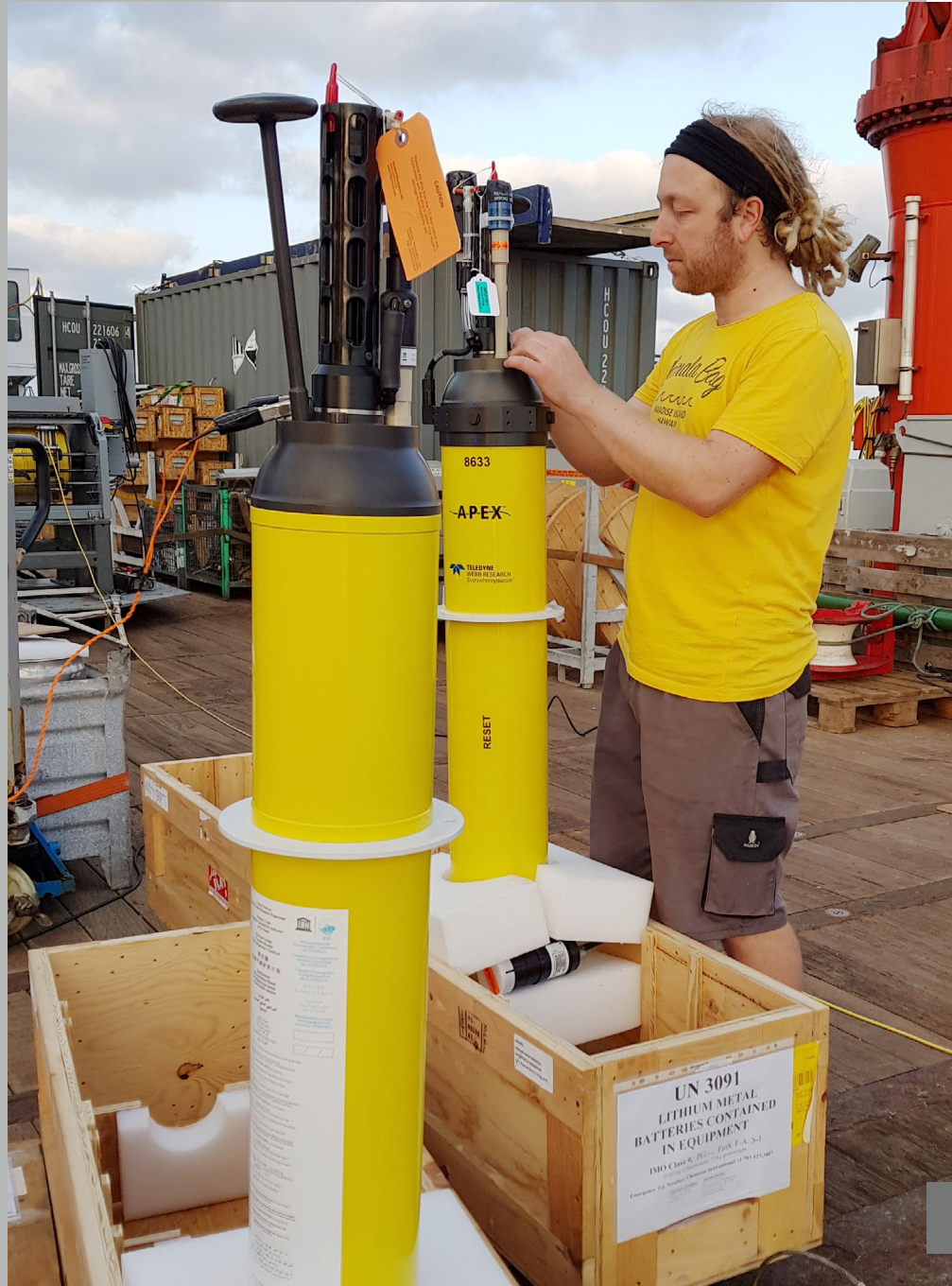
◀ Foto 3.13-2: Dr. Björn Fiedler vom GEOMAR Helmholtz-Zentrum für Ozeanforschung Kiel bereitet Argo-Tiefendrifter mit verschiedenen biogeochemischen Sensoren für die Auslegung im tropischen Atlantik vor.
