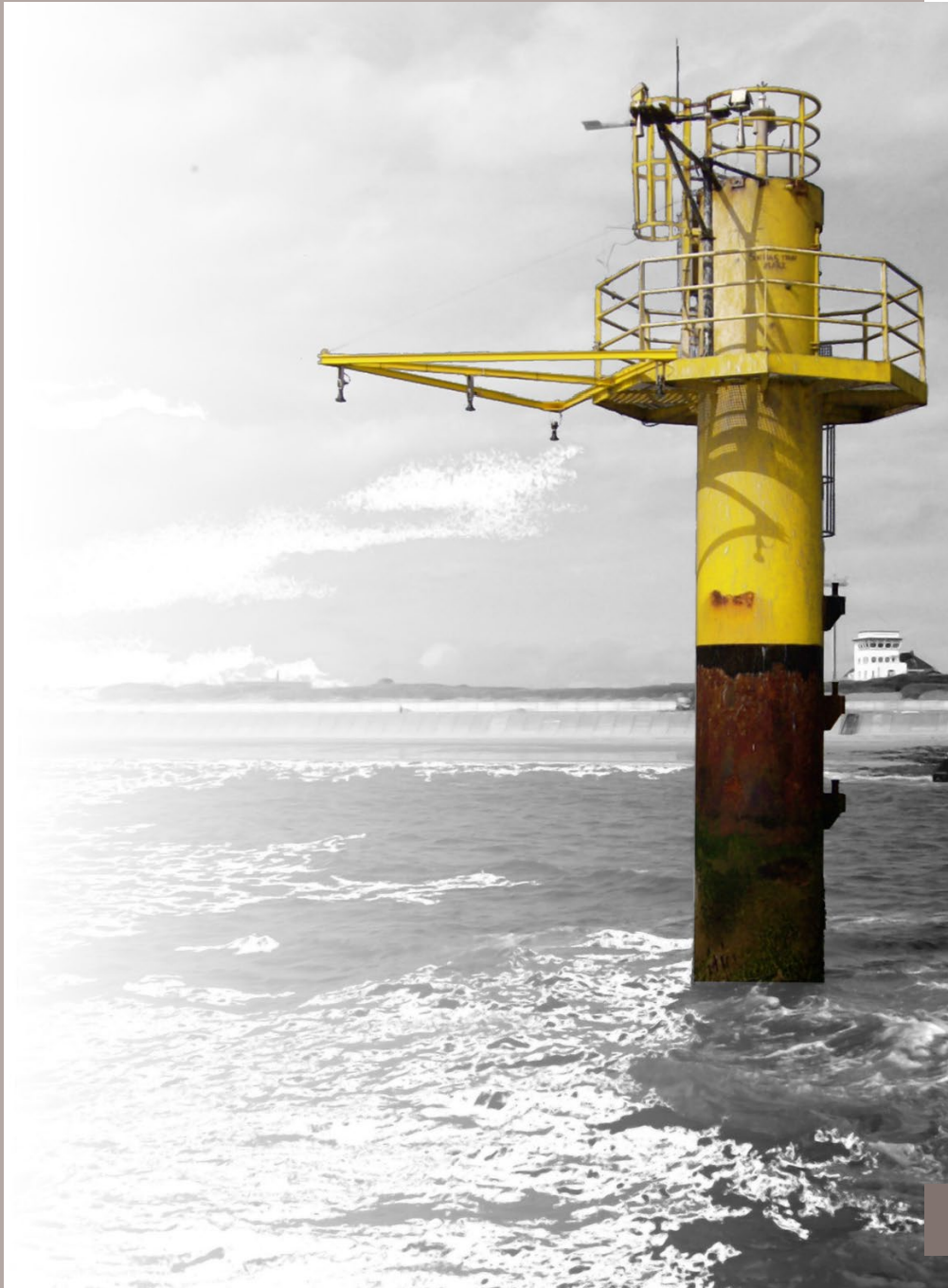
◀ Foto 4.1-3: Radarpegel Borkum-Südstrand mit vier Sensoren
