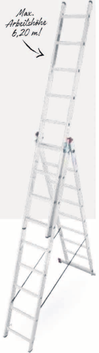
Alu-Vielzweckleiter Corda, vielseitig verwendbar als Anlage-, Schiebe- oder Stehleiter, Quertraverse für sicheren Stand, Leiterteile einzeln verwendbar, selbstsichernde Einrasthaken, rutschsichere Fußstopfen, TÜV-geprüft, max. Arbeitshöhe 6,20 m, versch. Ausführungen
