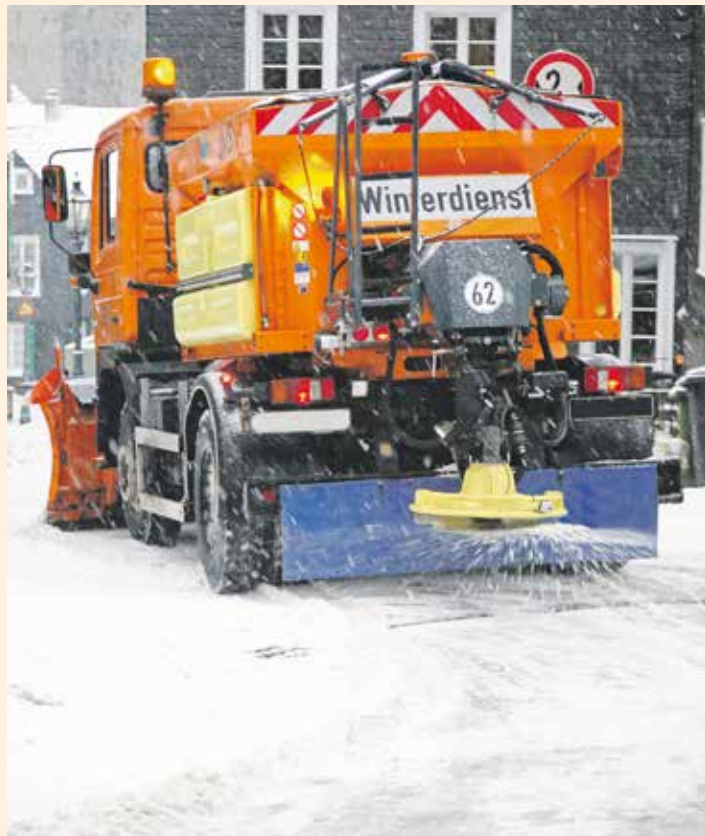
Der Winterdienst mit Feuchtsalz trägt maßgeblich zur Sicherheit im Straßenverkehr bei. Foto: djd/Verband der Kali- und Salzindustrie/flyingcowboy - stock.adobe.com
