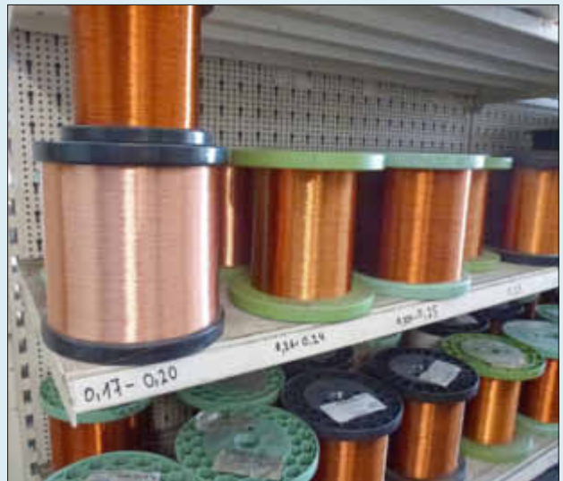
Kupferdraht, damit sind Spulen gewickelt.
