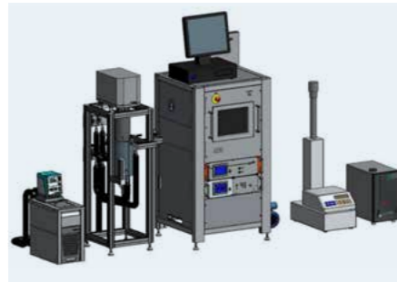
Die neue Gassorptionswaage im Fraunhofer LBF. ©Waters GmbH
