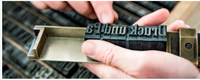
Der Handsatz, hier mit Bleilettern, ist das älteste Verfahren zur Herstellung von Druckformen mit beweglichen und einzelnen Lettern im Bleisatz für das Druckverfahren Buchdruck (Hochdruckverfahren) = „Presse“.
