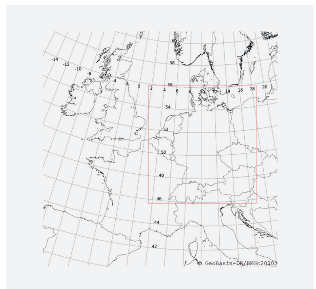
Abbildung 3-2: Das für Radarkompositprodukte definierte nationale Gebiet (roter Rahmen), eingebettet im internationalen Gebiet.
