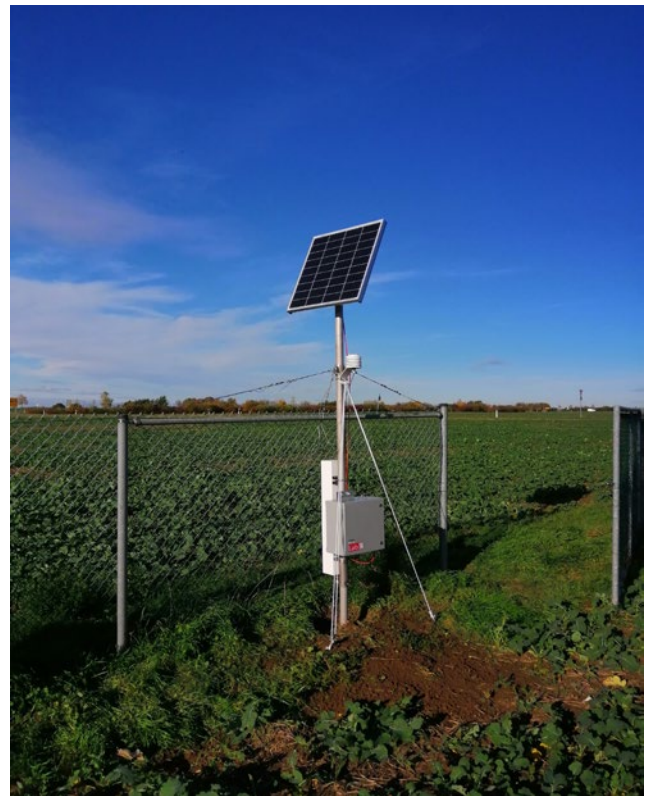
▲ DWD-Messsonde für Bodenfeuchte mittels Detektion solarer Neutronen am Standort Brandis der Staatlichen Betriebsgesellschaft für Umwelt und Landwirtschaft Sachsen.
