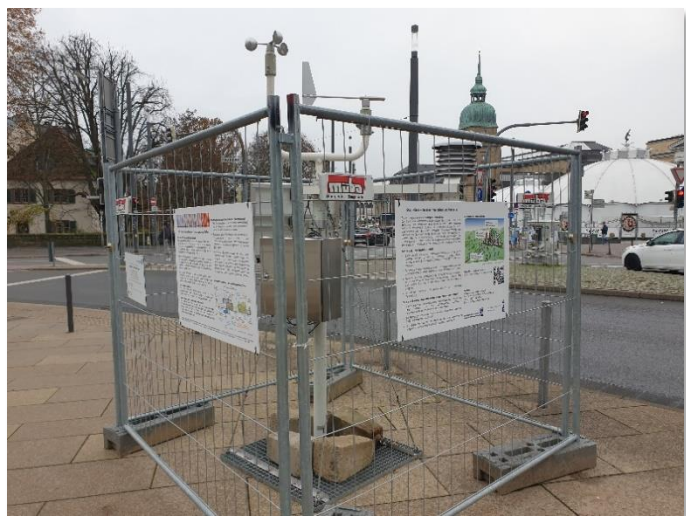
Abbildung 15: Mobile Stadtklimamessstation des Deutschen Wetterdienstes zur Erfassung des Wärmeineffektes am Darmstadtium
