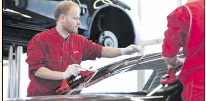
Die Reparatur von Glasschäden sollte in die Hände eines Kfz-Meisterbetriebs gelegt werden, da bei modernen Pkws nach einem Scheibentausch auch Assistenzsysteme neu kalibriert werden müssen.
