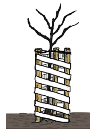
Dreibock mit Holzverschalung
