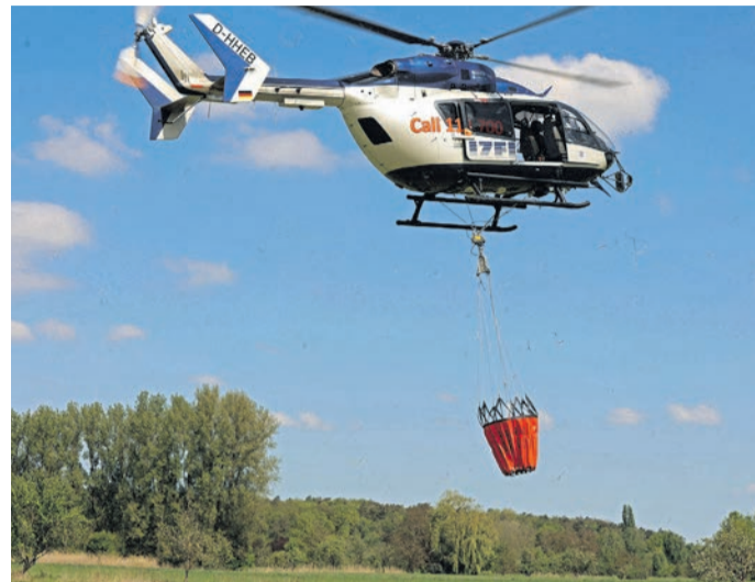
Der Hubschrauber der Polizeifliegerstaffel warf mit Hilfe eines „Bambi-Buckets“ Löschwasser über dem Wald ab.
