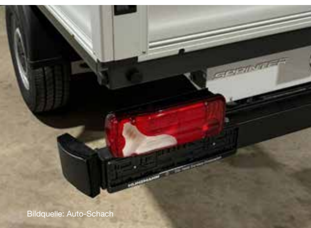
Abbiegesensor am Unterfahrschutz
