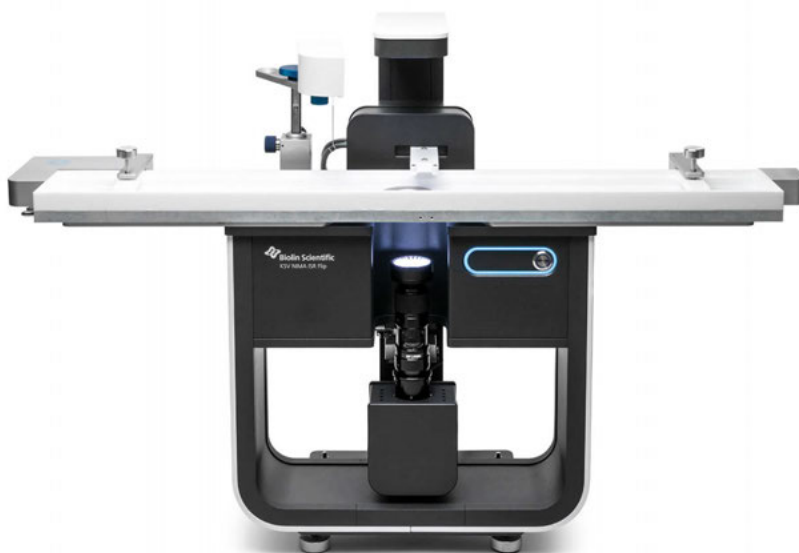
Abb. 1: ISR Flip mit High Compression-Trog, Kamera unterhalb des Trogs
