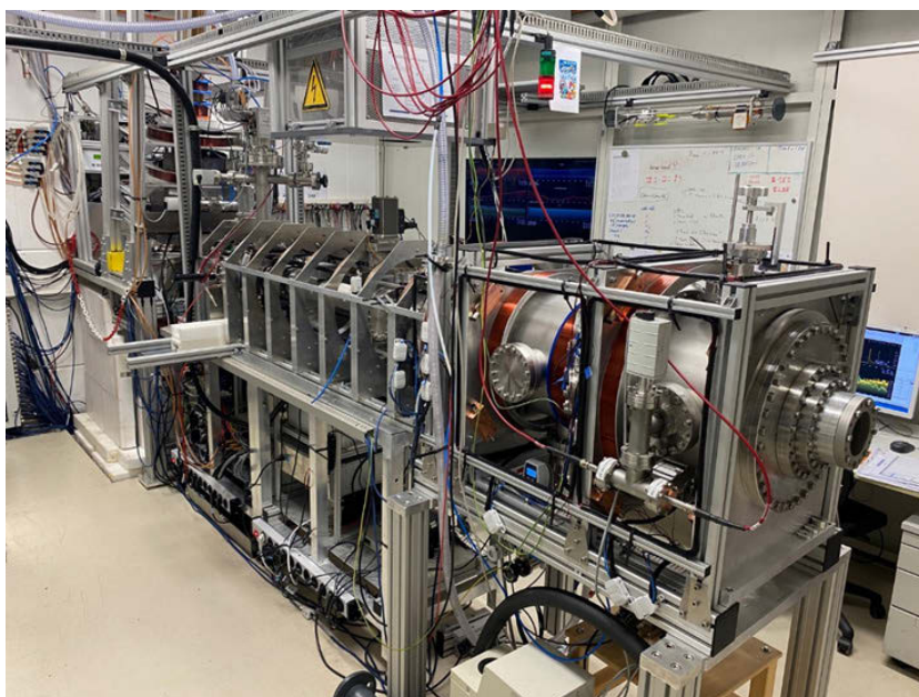
Abb. 1: Der hochintensive Positronenstrahl am ELBE-Zentrum für Hochleistungsstrahlenquelle zur Defektcharakterisierung und Porosimetrie
