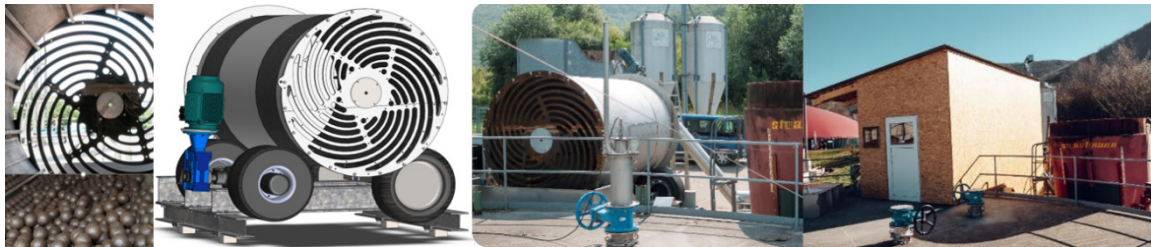
Abb. 1: Kugelmühle der Fa. Biokraft an der Versuchsstation Unterer Lindenhof, rechts mit Einhausung (© R. Heller, Fa. Biokraft)
