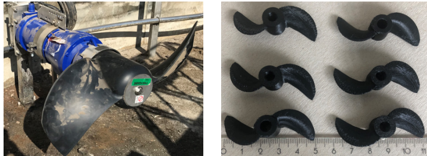
Abb. 1: Rührtechnik im Original vom Projektpartner PTM GmbH (links) und skalierte Modellpropeller (rechts) (© PTM GmbH)
