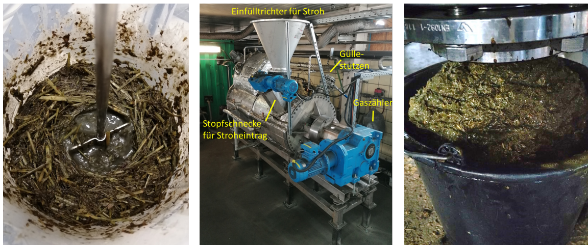
Abb. 1: (von links nach rechts) Stroh + Gülle mit Blattrührer, 800-L-Biogasreaktor, Gärrestprobe 800-L-Reaktor (© B. Schwarz)
